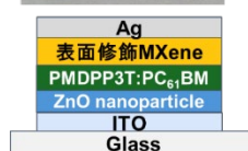
作製した光センサの構造と特性
