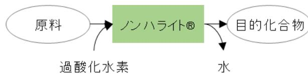
ノンハライト®を用いた粉体酸化反応により、透明性エポキシ原料や耐熱性エポキシ原料など、様々な機能性エポキシ原料を高転化率、高純度（高選択性）で合成することができます。また、その他酸化反応にも幅広く適用可能性があり、N-オキシドやスルホンを有する機能性ポリマーなど、高機能性有機材料を高純度かつハロゲンフリーで合成することができます。
